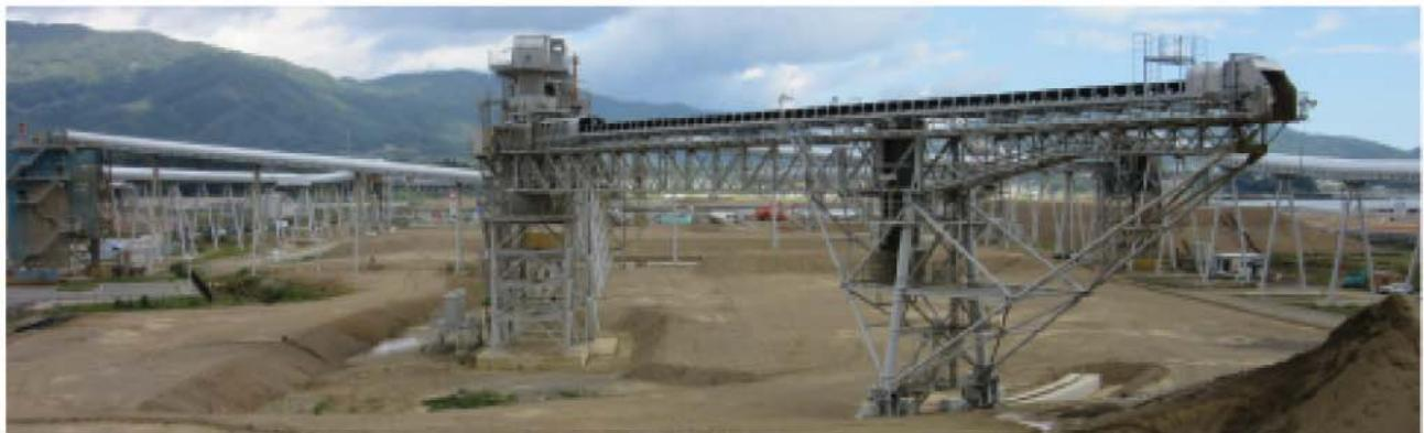
土地のかさ上げに使う土を運ぶ全長3キロメートルの巨大なベルトコンベア(陸前高田市)
